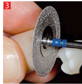
3 Durchtrennen von Presskanälen. Separation of press sprues. Taille de pointes de moulage.
