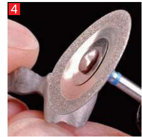
4 Anatomische Formgebung von NE Kronen und Brücken. Anatomical shaping of non-precious crowns and bridges alloys. Moulage anatomique de couronnes et bridges NE.
