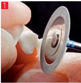
1 Bearbeitung von gehipptem Zirkondioxid. Trimming of sintered zirconia. Façonnage d'oxyde de zircon du type HIP.
