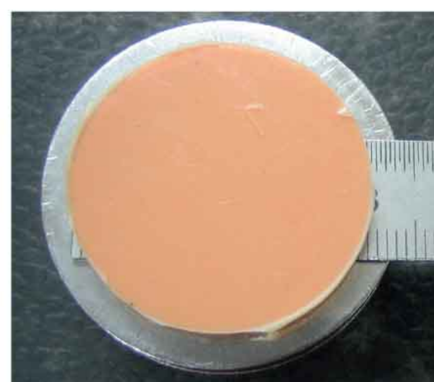
Mesure de la rétraction de xantasil ® après plusieurs semaines.
