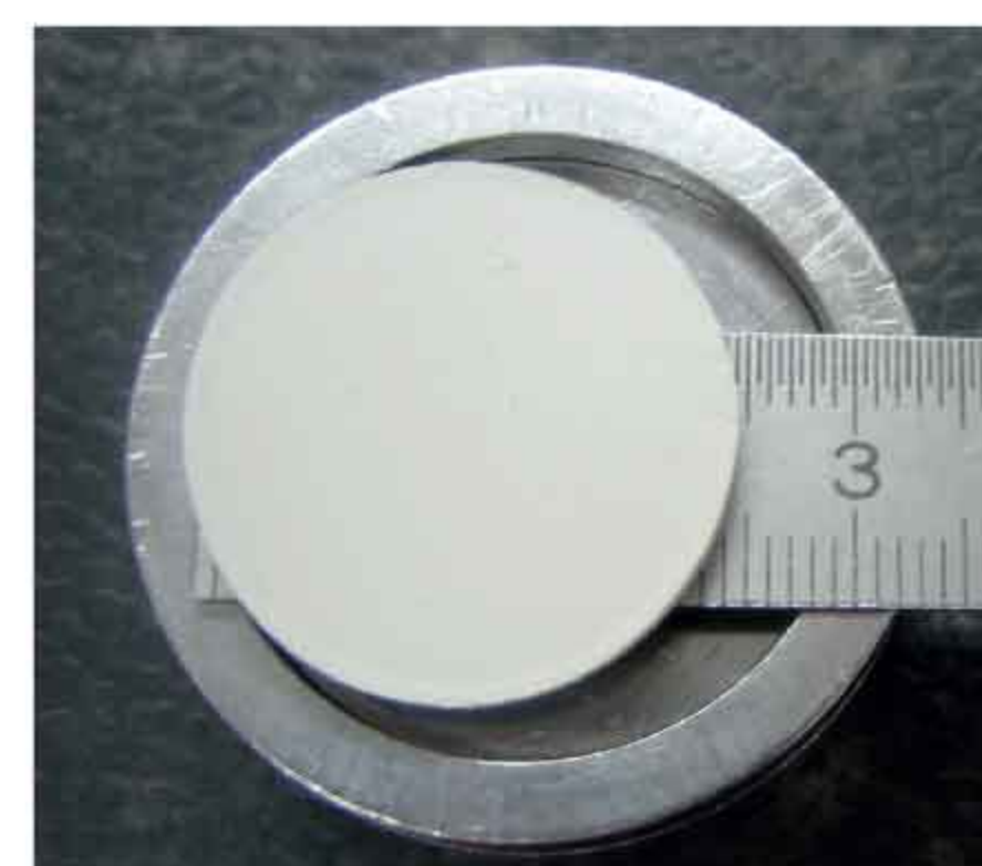
Mesure de la rétraction d'un alginate concurrent après 24 heures.
